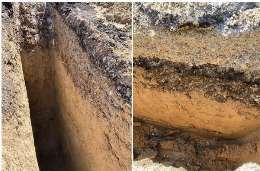
Figura 2.3 Detalle de calicatas realizadas.
